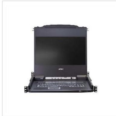
**KVM-Switch mit 8 Ports (USB - PS/2, VGA), 43cm-LCD-Bildschirm und USB-Port für Peripheriegeräte, ermöglicht es mehrere Computer von einer einzigen PS/2- oder USB-Konsole (Tastatur, Maus und Monitor) aus zu steuern. Ein einziger CL5708MW kann bis zu 8 Computer steuern**
