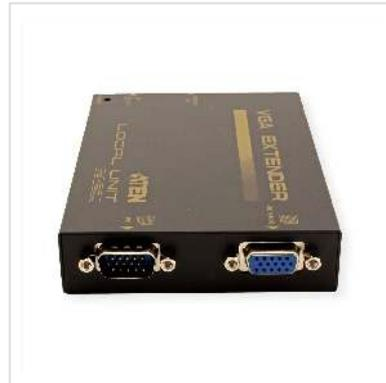
**Der Videoempfänger VE150AR kann zur Verstärkung von Signalen auf bis zu 150 m von der Quelle über ein Cat-5e-Kabel mit einem VE150AT verbunden werden. Er eignet sich ideal für Fabriken und Baustellen sowie andere Orte, an denen sich das Anzeigegerät möglicherweise in einer riskanten Umgebung befindet, Sie das System jedoch an einem sicheren Ort aufbewahren möchten.**
