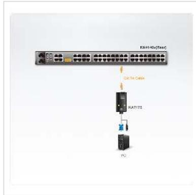
**ATEN KA7175 USB VGA Cat5e/6 Virtual Media KVM-Adapter. Das USB-KVM-Adapterkabel für virtuelle Datenträger KA7175 verbindet Ihren KVM-Switch mit den Grafik-, USB-Tastatur- und - Mausbuchsen des Zielcomputers.**
