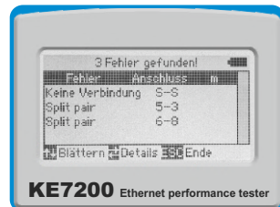
KE7200 Ethernet performance tester Detaillierte Fehlerinformation Detailed fault information
