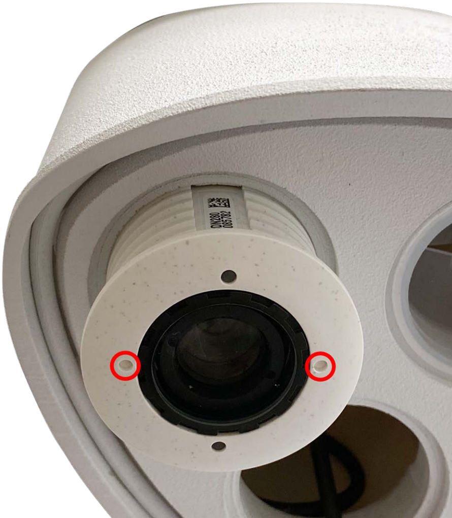
Abb. 10: Sensormodul ins Modulgehäuse einstecken
