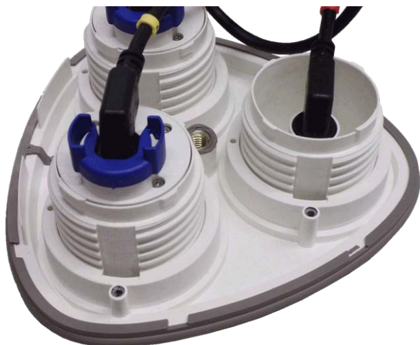
Abb. 13: Frontplatte mit Sensormodulen (Rückseite)
