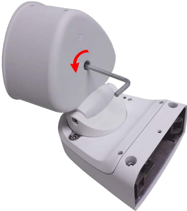
Abb. 12: Öffnen des Modulgehäuses
