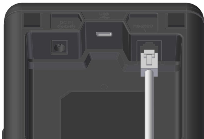
Illustration 12-2 Branchement du câble série à l'imprimante
