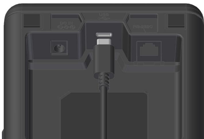
Illustration 12-1 Branchement du câble USB à l'imprimante
