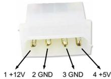
Um die EX-11042 zu betreiben, muss die Karte mit dem Stromanschluss vom PC-Netzteil verbunden werden!
