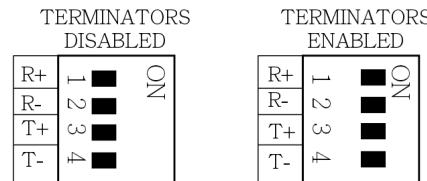
Terminator für RS-422 und RS-485 4-Draht Mode:
