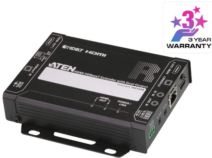
L'ATEN VE814AR est un récepteur vidéo HDBaseT pouvant recevoir les signaux HDMI jusqu'à 100 m sur un seul câble Cat 5e/6/6a ou ATEN [2L-2910](#) Cat 6. Ce récepteur compatible HDCP 2.2 répond aux spécifications HDMI, y compris 3D, Deep Color, au débit de données maximal de 10,2 Gbps et à la qualité vidéo 4K jusqu'à 100 m.
