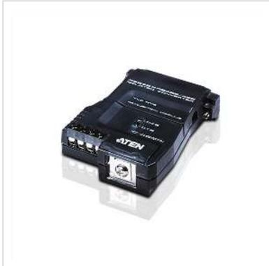
Der IC485AI ist ein 2-Wege-Konverter zwischen RS-232- und RS-422-/RS-485-Signalen für Übertragungswege bis 1200 m. Die eingebaute RS-485-Flusskontrolle und Richtungsüberwachung unterdrückt Signalüberlagerungen.
