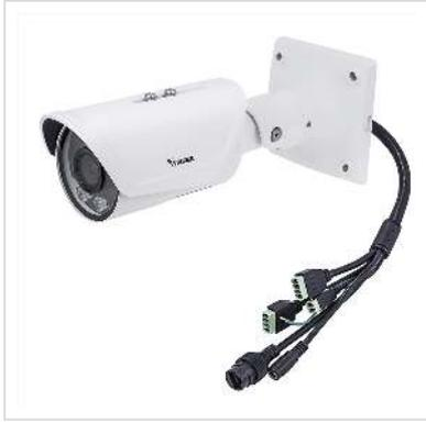
**VIVOTEK IB9367-H, Bullet Netzwerkkamera mit 2MP Auflösung 30 Bilder pro Sekunde, Smart IR, SNV, WDR Pro, Smart Stream III, PoE und 3,6mm fixes Objektiv für den Aussenbereich.**
