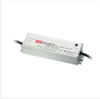
HLG-120H-24 Industrie Netzteil 90~305VAC in, 24VDC/120W out, IP68, geeignet für den Einsatz im Innenbereich und Außenbereich
