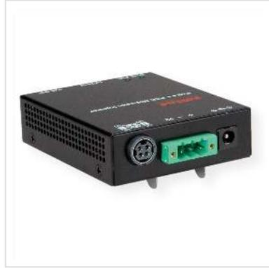
**Der ROLINE Gigabit PoE++ Injektor ist ein sogenanntes PSE, ein Gerät zur Stromversorgung für z.B. Überwachungskameras und LAN-Geräte wie Access Points, Bridges und Router über Ethernet-Kabel. Ein PSE speist Strom zu den Daten in das Netzkabel ein. Es muss dann kein eigenes Netzteil mehr an dem LAN-Gerät angeschlossen werden.**
