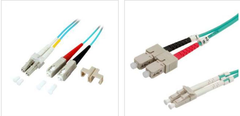
Die Verwendung von 50/125µm-Fasern in OM3-Qualität erlaubt bei hohen Übertragungsbandbreiten (ab Gigabit Ethernet) die Überbrückung größerer Distanzen. So ist bei 1000Base-SX eine Entfernung von 900m möglich - statt 550m mit "normalen" 50/125µm-Fasern (OM2). Bei 10GBase-SR ermöglicht OM3 eine Strecke von 300m gegenüber 80m bei OM2.
