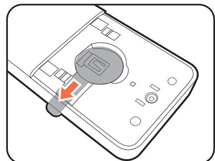
4. Legen Sie die mitgelieferte Batterie (CR2032) in die Batteriehalterung ein. Achten Sie darauf, dass der Pluspol (+) nach oben zeigt.
