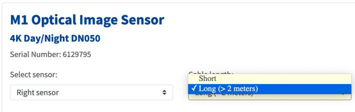
Gehen Sie zum Admin Menu - Hardware Konfiguration - Sensor Modul Konfiguration und setzen Kabellänge auf "Long (>2 meters)" und starten die Kamera danach neu.
