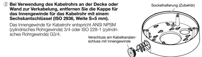
**② Bei Verwendung des Kabelrohrs an der Decke oder Wand zur Verkabelung, entfernen Sie die Kappe für das Innengewinde für das Kabelrohr mit einem Sechskantschlüssel (ISO 2936, Weite S=5 mm).**
