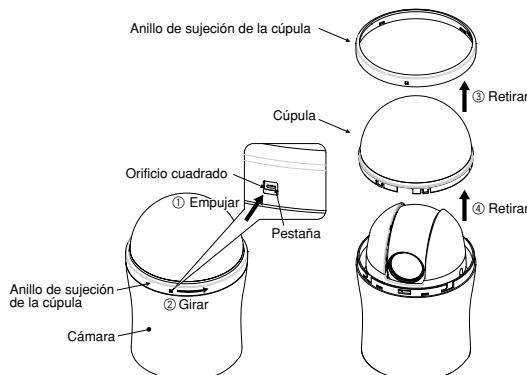
**2** Alinee el gancho de la cúpula (tipo ahumado) y el orificio de agarre de la cámara e instale la cúpula.
