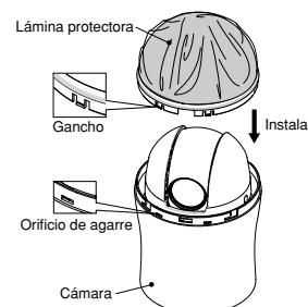
**3** Instale el anillo de fijación de la cúpula. Alinee el símbolo ▼ situado dentro del anillo de fijación de la cúpula y la flecha de la cámara e introduzca el anillo de fijación de la cúpula.
