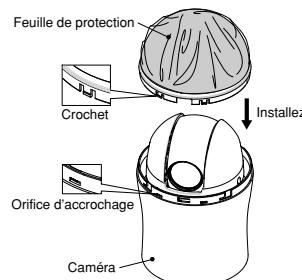
**3** Installation de la bague de fixation du dôme.
