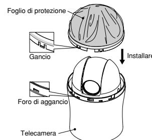
**3** Installare l'anello di fissaggio della cupola. Allineare il simbolo ▼ all'interno dell'anello di fissaggio della cupola e la freccia della telecamera, inserendo l'anello di fissaggio della cupola.
