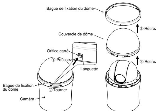
**2** Alignez le crochet situé sur le couvercle de dôme (type anti-fumée) et l'orifice d'accrochage situé sur la caméra, et installez le couvercle de dôme.
