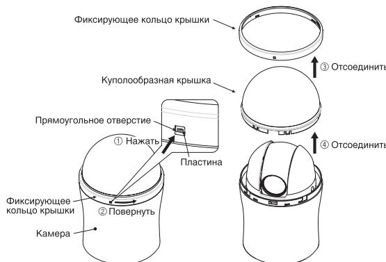
**3** Установите фиксирующее кольцо. При установке фиксирующего кольца крышки совместите метку ▼ на внутренней стороне фиксирующего кольца со стрелкой на камере. Зафиксируйте фиксирующее кольцо крышки, повернув его по часовой стрелке.
