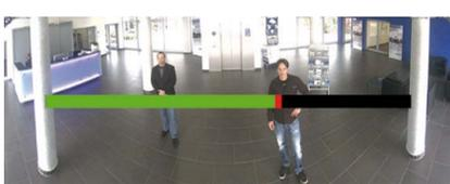
Faites pivoter doucement l'objectif d'un côté puis de l'autre à l'aide de la clé d'objectif grise, jusqu'à ce que la zone rouge de l'aide à la mise au point ait disparu autant que possible. Retirez la clé d'objectif après chaque modification du réglage de la netteté.
