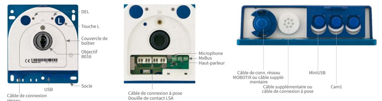
Dans des cas particuliers, vous pouvez attacher un module capteur d'images externe à la S26. En ce cas, branchez le module externe au connecteur « Cam1 » de la caméra. Puis, suivez les instructions concernant le branchement d'un capteur externe de la S16. Après la configuration du capteur externe, le capteur d'images intégré de la S26 est déconnecté.
