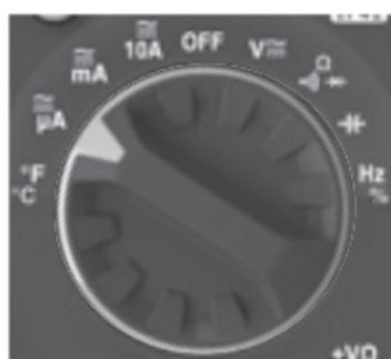
2. Stromstärke messen: Machen Sie den Stromkreis spannungslos, öffnen Sie den Stromkreis am Messpunkt, schließen Sie das Messgerät mit den Messleitungen in Reihe am Stromkreis an und legen Sie den Stromkreis an Spannung. Das Messgerät sucht automatisch den Messbereich, der am besten geeignet ist, und zeigt diesen im Display an.
