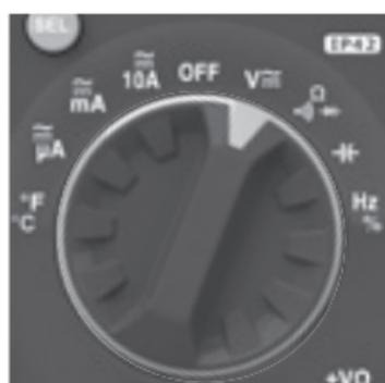
2. Legen Sie die Messleitungen am zu messenden Stromkreis an, um die Spannung zu messen. Das Messgerät sucht automatisch den Messbereich, der am besten geeignet ist, und zeigt diesen im Display an.
