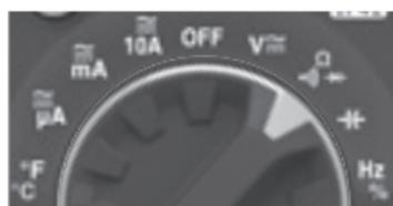
**HINWEIS:** Sind die Messleitungen in einer Widerstandseinstellung offen (nicht über einen Widerstand miteinander verbunden) oder wird ein defekter Widerstand gemessen, zeigt das Display „OL“ an. Das ist normal.
