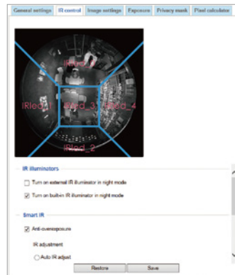
Unabhängige Infrarot-Steuerung für regionale Beleuchtung
